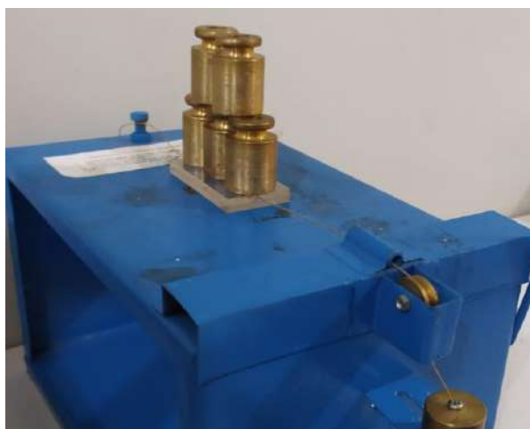
Gambar 4.11 Uji daya lekat
