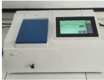
Gambar 2.5 Instrumen Spektrofotometer UV-Vis (Anonim, 2020)
