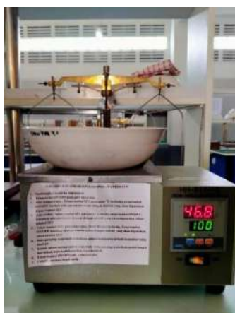
(e) Proses pemekatan maserat dengan metode waterbath
