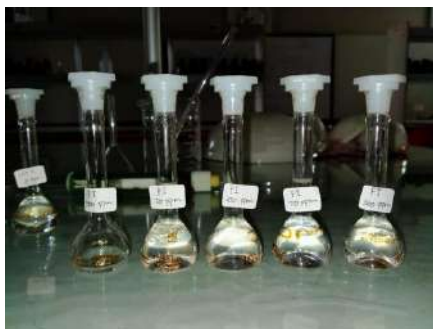
(c) Pembuatan larutan stok dan seri konsentrasi sediaan masker peel off
