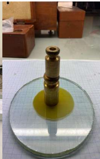
Uji Daya Sebar
