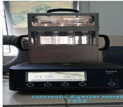
Sampel yang sudah di dalam tabung dimasukkan ke mesin destruksi
