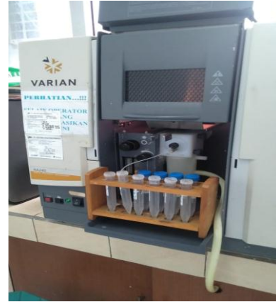
Diukur absorbansi sampel Dengan panjang gelombang 422,7 nm
