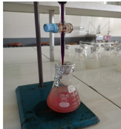
10 sampel di titrasi dengan \text{KMnO}_4 secara perlahan – lahan dan di goyangkan perlahan
