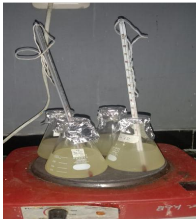
10 sampel Sampel dipanaskan hingga 70^{\circ}\text{C} secara duplo
