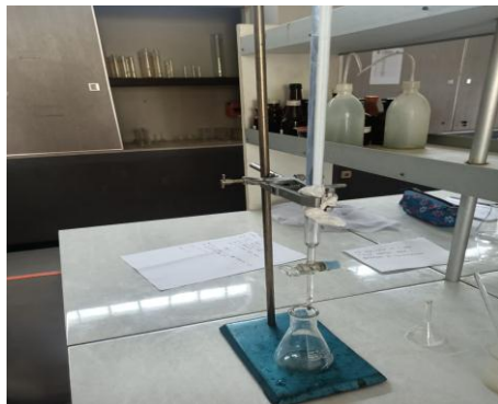
Sampel di titrasi dengan \text{Na}_2\text{S}_2\text{O}_3
