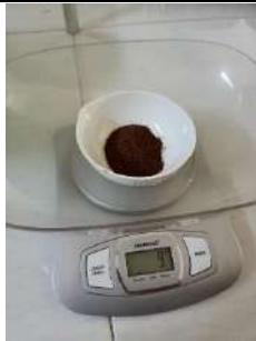
(a). Uji kadar air
