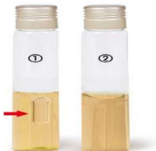
Gambar 2.9 Hasil positif dengan adanya gelembung udara (kiri), hasil negatif tidak adanya gelembung udara (kanan) (Dhafin, 2017)
